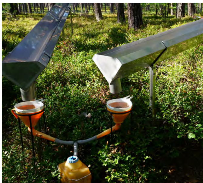
Abb. 20: Niederschlags erfassung im Bestand (Intensivmessfläche Kienhorst, Foto: W. Riek)
