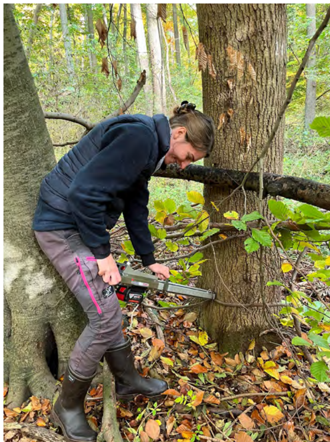
Abb. 42: Resistografie an geschädigten Eschen (Bild: Henriette Häuser, LFE)
