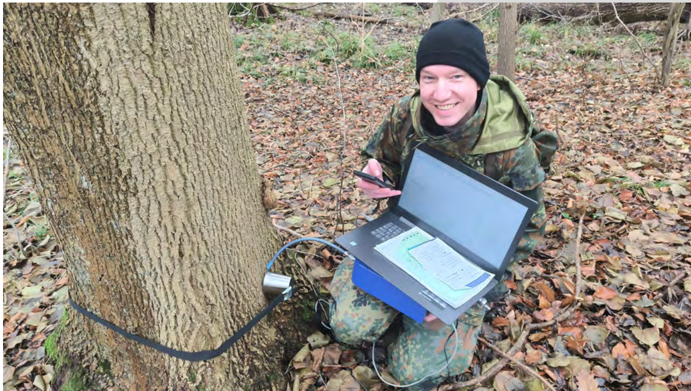
Abb. 44: Messung von flüchtigen organischen Verbindungen (VOCs=Volatile Organic Compounds) mit Hilfe einer speziellen elektronische Nase (PEN3-Sensor, Firma AIRSENSE Analytics GmbH) (Bild: Henriette Häuser, LFE)
